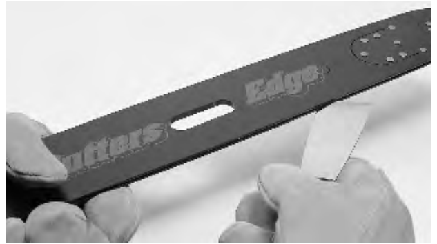
Fig. 27. Cleaning bar groove
