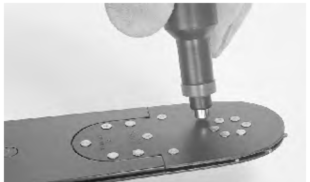
Fig. 29. Lubricating sprocket bearings
